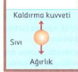
İtme kuvvetlerinin bileşkesi olan kaldırma kuvveti yukarı yönlü olur
