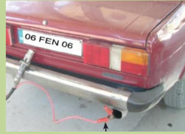
LPG dolumu sırasında topraklama
